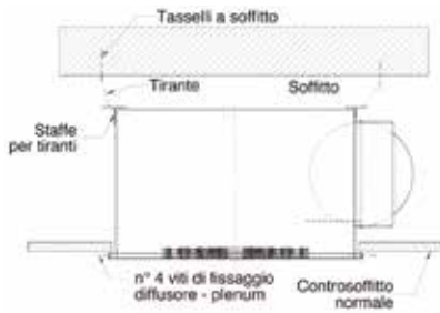
Installazione con Plenum PQ0S o PQ0I su controsoffitto normale
